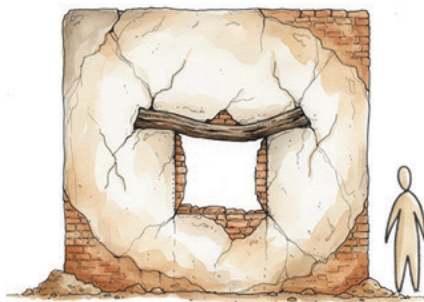
Figura 7. Ejemplo de lesiones en vano con falla en dintel y jambas.
