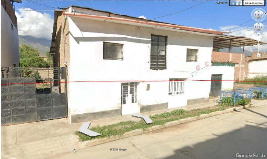
Fotografía 1. Vivienda ubicada en el CA. Cruz Viva Nro. 187, Caraz. Anterior a su demolición, nótese los dos niveles constructivos edificado con material rustico (adobe). Fuente Google earth 2024.
