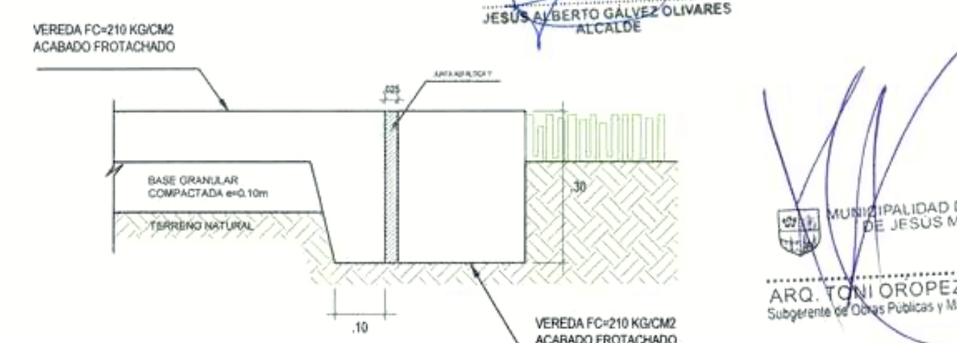
DETALLE TÍPICO DE VEREDA CON SARDINEL DE ADOQUIN ESCALA: 1/10
