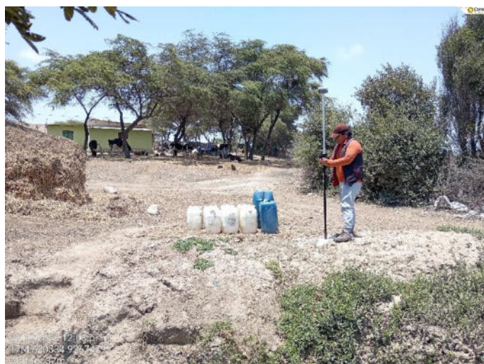
Foto 14. Levantamiento de la poligonal perimétrica con el uso de equipo diferencial de alta precisión.
