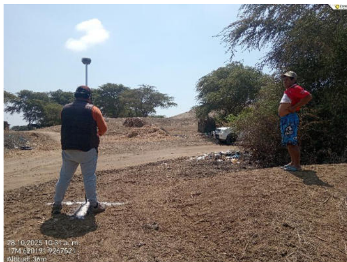
Foto 13. Levantamiento de la poligonal perimétrica con el uso de equipo diferencial de alta precisión.
