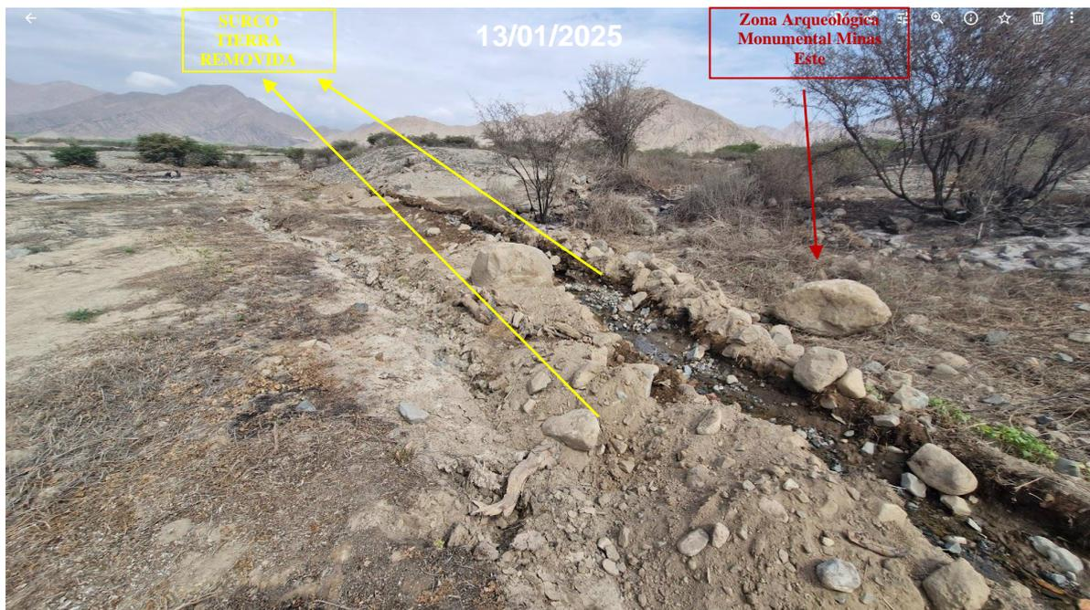
**Foto 4:** Zona Arqueológica Monumental Minas Este. Vista panorámica de la ampliación de un surco preexistente con maquinaria pesada (en color amarillo), ubicada al interior de la propuesta de poligonal (en color rojo). Nótese a la tierra removida al costado del surco. **Foto tomado el 13 de enero de 2025.**
