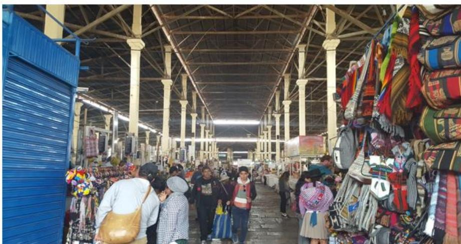
VISTA INTERIOR DEL PASE CENTRAL DE CIRCULACION, EN EL QUE SE OBSERVAN LOS PILARES DE TRES CUERPOS Y DE TRES TAMAÑOS, QUE SOPORTAN LA ESTRUCTURA DE MADERA SOBRE EL QUE VA LA COBERTURA DEL GRAN TECHO
