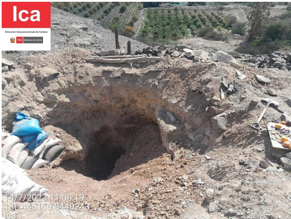
**Imagen 08:** vista panorámica de la excavación minera en pique, a la vez se observa herramientas de trabajo, costales con material extraído y así como un tablero con frutas y dulces a manera de ofrenda.
