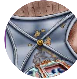
4. Filtración de agua en techos
