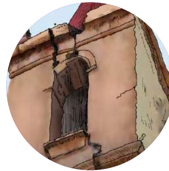
Fallas en muros que generen colapso
